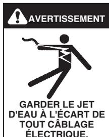
**AVERTISSEMENT:** Garder la lance, le boyau et le jet d'eau à l'écart de tout câblage électrique ou des chocs électriques mortels pourraient survenir.
